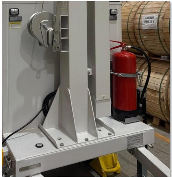
3.3 Con el mástil fijado al cuadro/estructura se procede a pasar los cables de alimentación y datos al interior del equipo.
