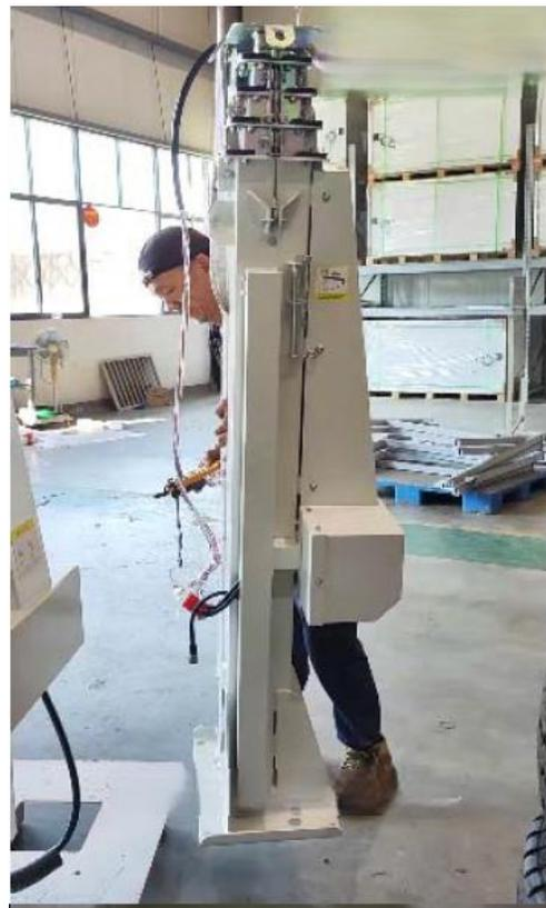
3.2 Una vez colocado el mástil se procede a alinear los orificios del mástil con los del cuadro/estructura del equipo e instalar los tornillos de M12X40
