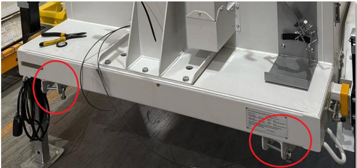
2.1 Se coloca el cuadro o Barra de arrastre en el bastidor del equipo verificando que los orificios de ambos estén alineados y se procede a colocar los tornillos y pasadores de seguridad
